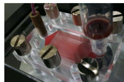
ポリマー-CTC チップを チップホルダーにセット (血液送液中)
